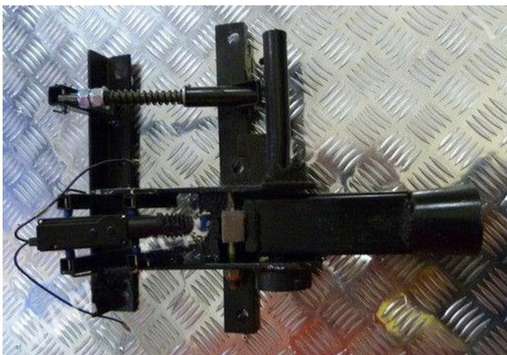
Рисунок 5 – механизм фиксации и выдачи груши.
