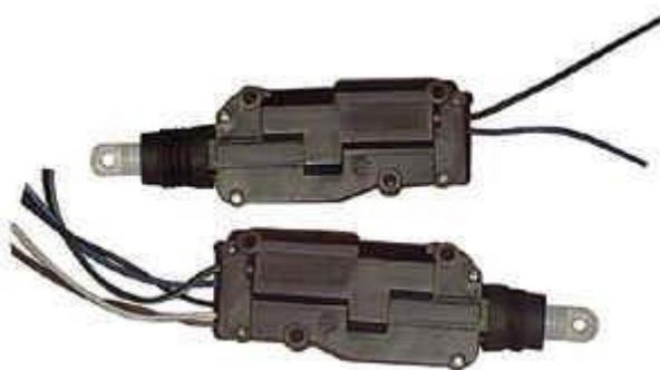
Рисунок 5.1 – Активатор (привод центрального замка автомобиля Saturn ms-200)
